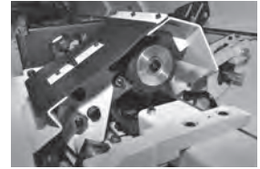
中間振れ止め装置
