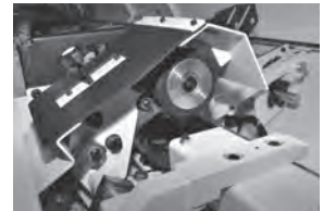
中間振れ止め装置
