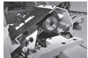
中間振れ止め装置
