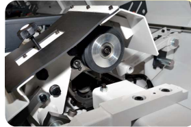
中間振れ止め装置
