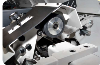
中間振れ止め装置
