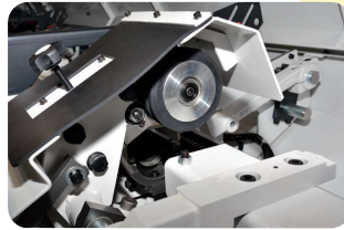
中間振れ止め装置
